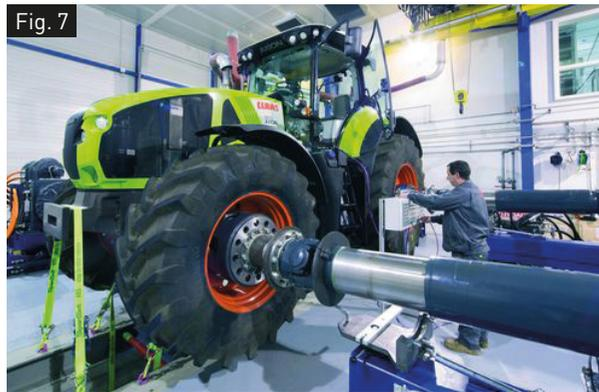
Figura 7 – Banco di prova per macchine agricole (trattori, mietitrebbiatrici) a "quattro postazioni indipendenti" installato nel 2015 da Claas nel suo stabilimento a Trangé, in Francia (figura tratta da: <http://www.agricolturanews.it/files/2015/03/240463-3.jpg>).
