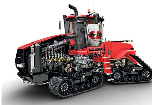
**Fig. 10** - Case CVXDrive installata su trattore articolato dotato di semicingoli della serie Steiger (Fonte: <https://www.caseih.com/northamerica/en-us/products/tractors/steiger-series>).
